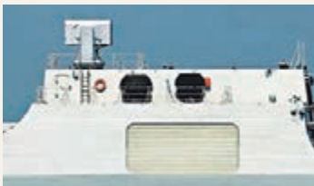
■艦尾機庫上的近防導彈系統。 網上圖片
