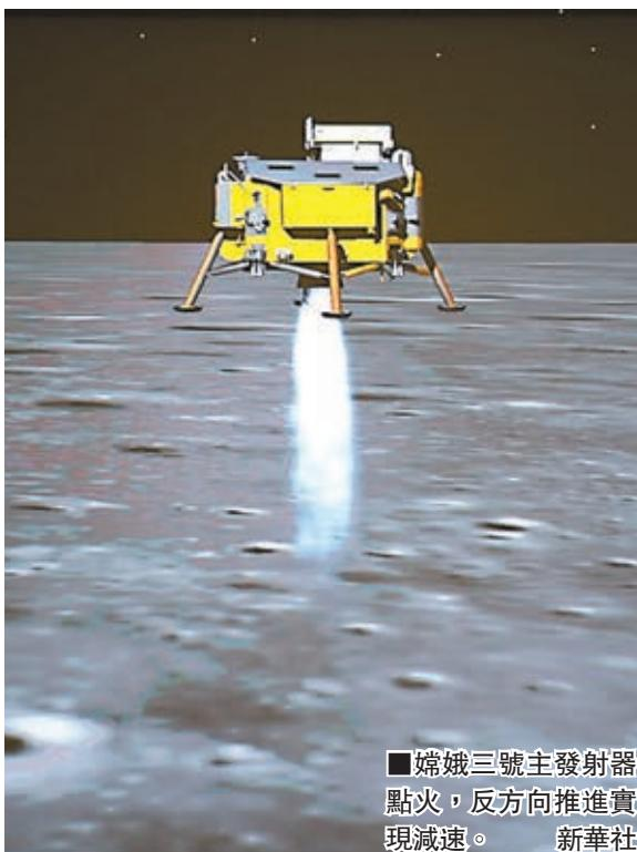
■嫦娥三號主發射器點火，反方向推進實現減速。 新華社
