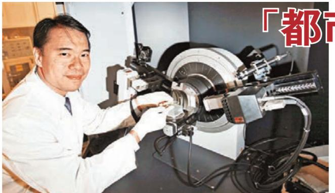
施凱閔表示，透過X射線衍射可從材料標準圖譜分析當中的成分、原子或分子的建構等資料。
