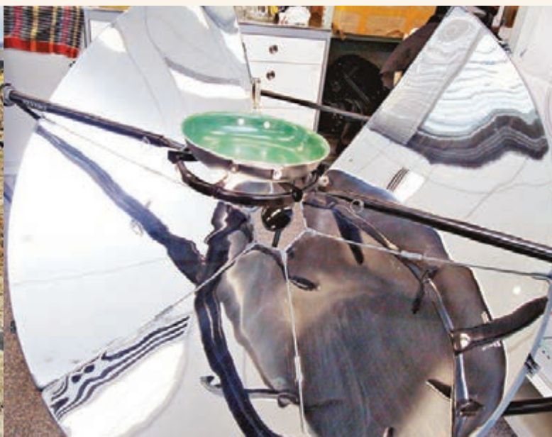
■One Earth Designs為中國農牧居民而設的便利煮食灶。該灶聚集高原的太陽能發電，能於10分鐘內煮沸1公升水。 黃偉邦 攝
