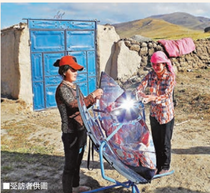
■One Earth Designs為中國農牧居民而設的便利煮食灶。該灶聚集高原的太陽能發電，能於10分鐘內煮沸1公升水。 黃偉邦 攝
