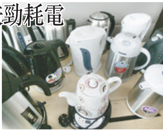
消委會測試15款電熱水煲，發現加熱快慢有明顯分別，而個別樣本在保溫過程中，需消耗不少電能。
