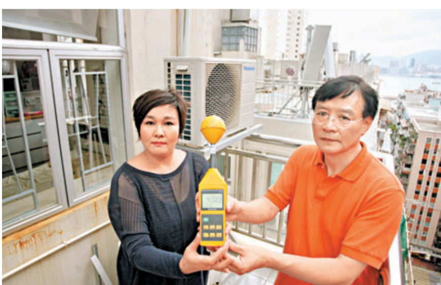
王國興與霍女士在住所測量對面大廈的手機發射站產出的輻射,顯示為4.388 V/m,專家指此數值不利人體健康。
