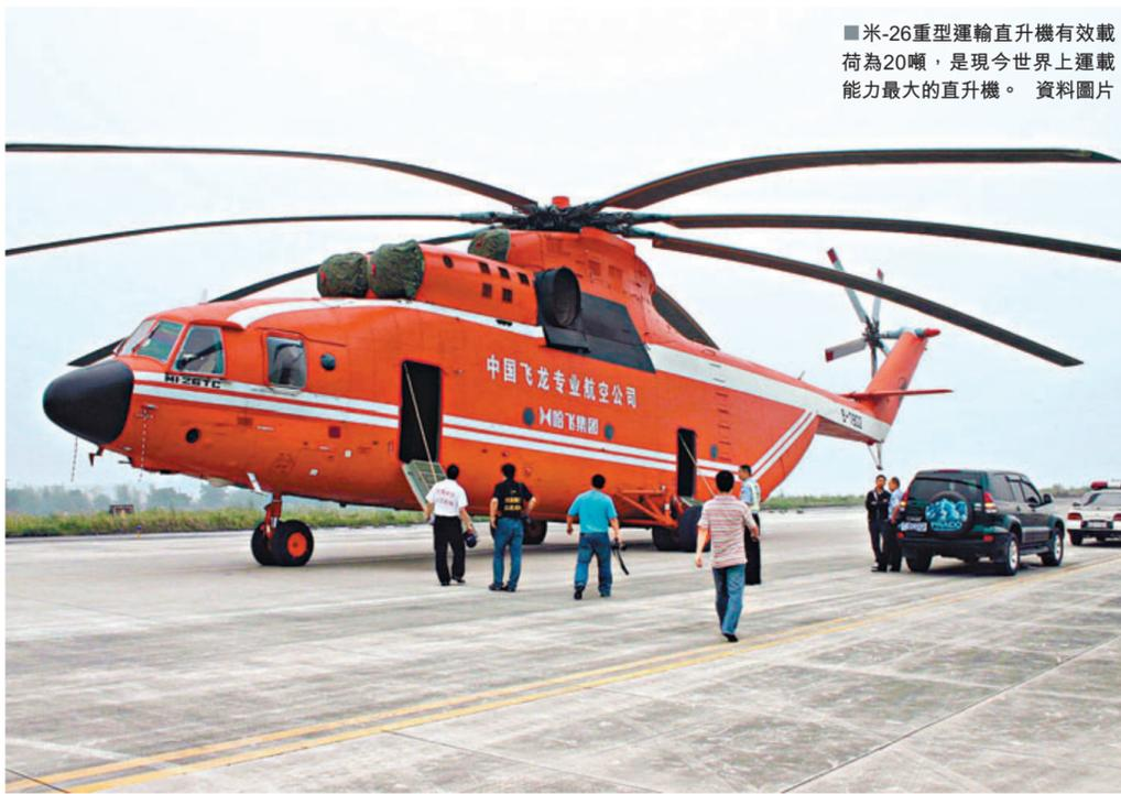
米-26重型運輸直升機有效載荷為20噸，是現今世界上運載能力最大的直升機。 資料圖片
