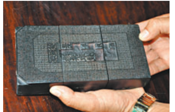
■瑞誠號票號的模具，分成三塊，中間用象牙籤串在一起，上刻「憑票取錢」四字。
