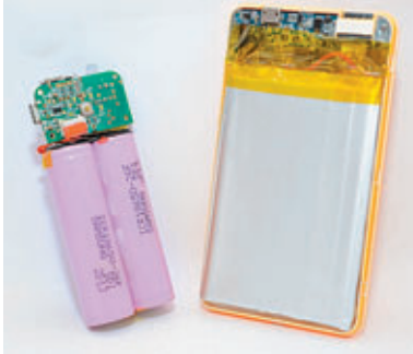
■不論流動電池內使用鋰離子電池（左）或鋰離子聚合物電池（右），如電池出現膨脹應立即停用並棄置。
