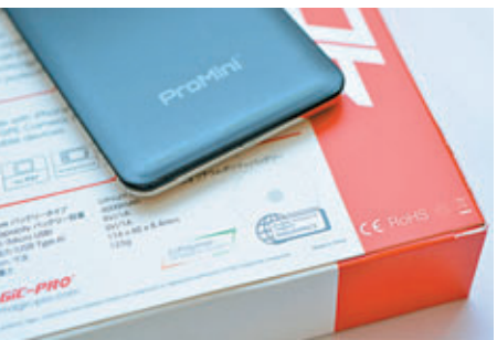
■選購流動電池時，用家可留意包裝盒上標示所用的電池種類，以及已通過的認證，其中的ProMini 4000s就使用已通過CE認證的鋰離子聚合物電池（Li-Polymer）。
