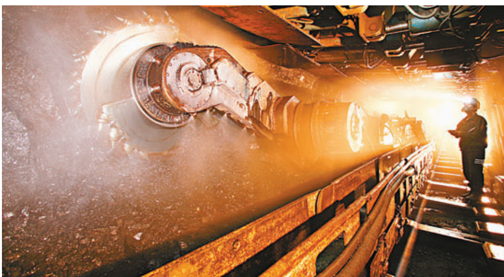
植根於全球最大的煤炭消費國, 兗州煤對煤炭需求有把握, 私有化計劃若成事將可以廉價就獲得額外煤炭供應。圖為兗礦採礦技術——綜採放頂煤工藝。
