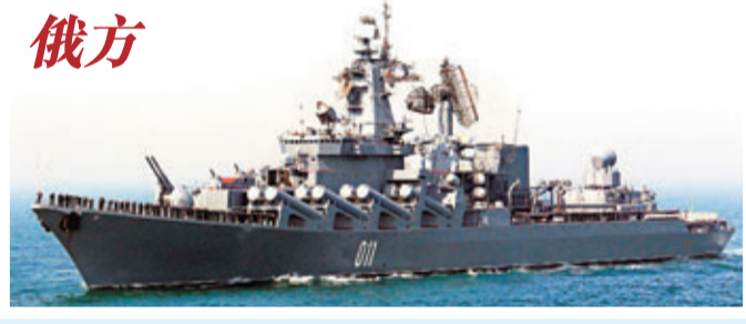
「光榮級」巡洋艦瓦良格號(舷號011)： 全長：186米 排水量：1.1萬餘噸 續航力：7,500海里/18節 武器裝備：8座雙聯SS-N-12「沙箱」遠程超音速反艦導彈發射裝置，有指令修正慣性制導，主動雷達尋的功能。1.7馬赫時射程550千米。戰鬥部為350千噸當量的核彈頭，或1,000千克高能裝藥。可攜帶1架卡-27直升機
