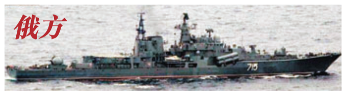
「航母殺手」快速導彈驅逐艦(舷號715)： 全長：156.37米 排水量：7,900噸，滿載8,480噸 續航力：2,400海里/32節 武器裝備：四聯裝的MOSKIT(SS-N-22「日炙」)超音速巡洋導彈發射器2座
