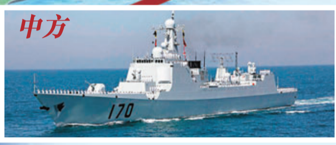
052C型導彈驅逐艦蘭州艦(舷號170)： 全長：155.5米 排水量：6,000噸 航速：29節 武器裝備：有「中華神盾」多功能相控陣雷達；海紅九導彈垂直發射裝置，能同時攔截多批空中目標
