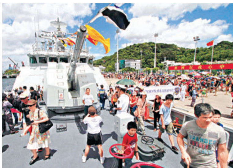
30毫米輕型遙控艦炮能全自動遙控及人工操縱射擊。 彭子文 攝
