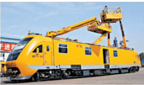
■擁有「高鐵救護車」美稱的時速160公里接觸網多功能綜合作業車。
