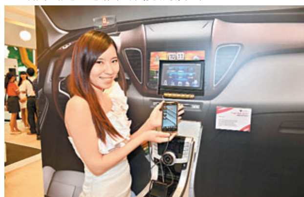
THINK+ Touch為台灣汽車品牌納智捷與HTC共同研發的汽車使用介面。透過USB線連接並使用「HTC模式」就可以透過汽車內的屏幕使用HTC智能裝置。
