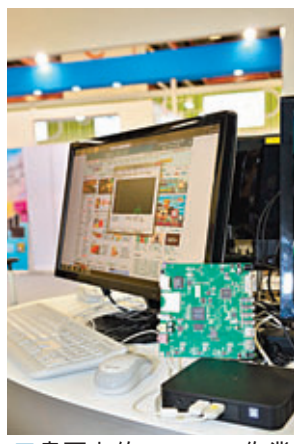
畫面上的Windows作業系統也是載於伺服器內，客戶端設備透過網絡傳送的壓縮畫面解壓和傳送用家透過鍵盤、滑鼠輸入和輸出的能力。
