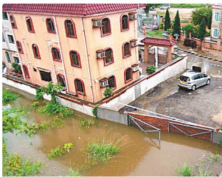
■私家地的磚牆取代鐵欄後,如水壩般令雨水無法疏導,形成人工水塘。
