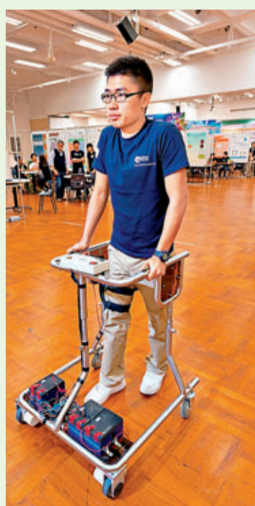
城大生研製「電動復康助行器」，助行器的電腦操控部件可引導並協助病人大腿擺動，以便移步行走。城大供圖
