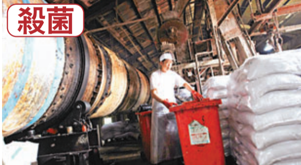
殺菌 步驟三：按份量，將物料放入攝氏180度的烘乾爐，進行6小時的烘乾、殺菌、烤熟過程。 劉國權攝
