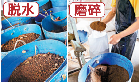
脫水 磨碎 步驟四：為延長儲存期，工場會再徹底蒸乾水份，脫水過程約2小時。 步驟五：最後將材料磨碎，成為可供調配作飼料的「基礎料」，部分運至另一廠房再製成魚糧。 劉國權攝
