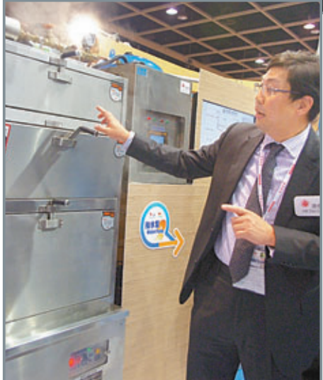
港燈集團銷售及市場高級經理江耀光介紹餘熱回收系統，機器可把蒸餾過程中80%的廢蒸氣回收再用。 蔡明暉 攝
