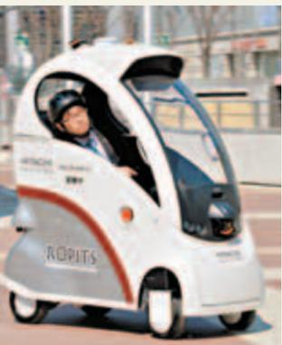
日本日立公司前日展示一款短距離代步機械人車(見圖), 只需輸入信息就能自主行駛至目的地, 途中還能避開行人和障礙物。這款車有望應用於老年人和殘疾人的市內短距離出行。這款名為「ROPITS」的電動車配備四小輪及單座。雖然迷你小巧, 但全身「高科技武裝」。除了GPS接收裝置外, 還裝備多套距離感測器和三維相機, 可感知路上各種複雜環境。加上日立研發可再現實際環境的三維環境地圖軟件, 使機械人車根據地圖準確識別坐標, 靈活移動。■《每日郵報》
