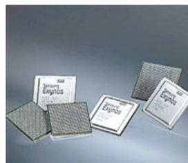
新處理器由兩個4核心處理器組成，透過ARM big.LITTLE技術，可在進行不同運算時，自動選擇適合的處理器運作，提升效率及電池壽命。
