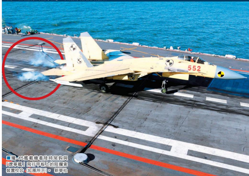
殲-15艦載機着陸時尾鉤與「遼寧艦」飛行甲板上的阻攔索裝置咬合(紅圈所示)。
