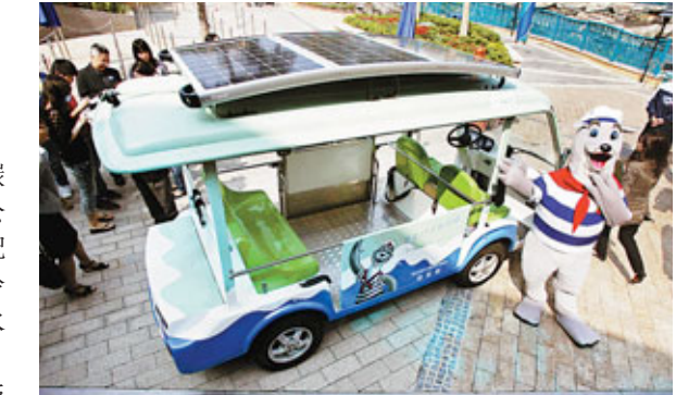
海園為24輛電動運輸車安裝太陽能電池板系統。
