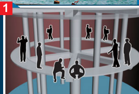
19名工人坐在俗稱「鳥籠」的鋼造大沉箱內的可升降滑輪工作台上。
