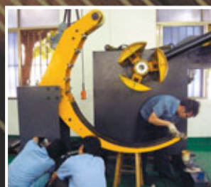
■平整送料機可記憶100個產品的規格數據，顯示自我診斷故障的結果。香港文匯報記者郭若溪攝
