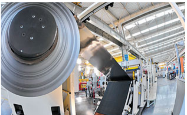
■新興產業基地——太鋼精密帶鋼生產線，生產的精密帶鋼的厚度僅為頭髮絲的三分之一。
