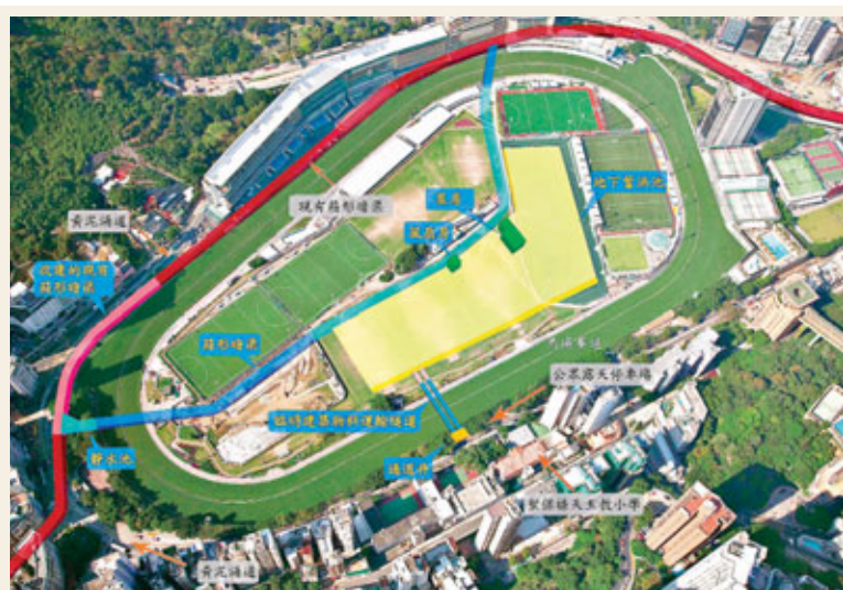
渠務署預計耗資約10億元,在跑馬地遊樂場地底,興建1個容量達60,000立方米的地下蓄洪池。記者 陳錦燕攝
