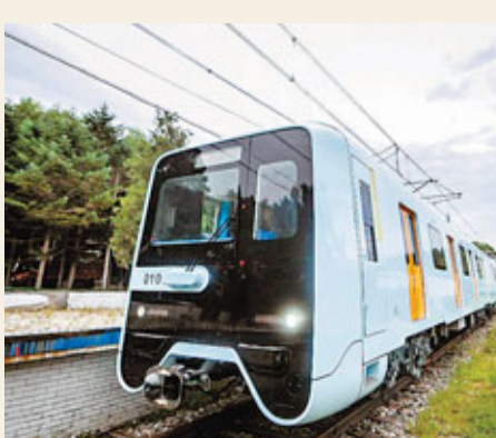
高寒列車採用新型標準B2型鋁合金地鐵車，「四動兩拖」6輛編組，最高運行速度每小時80公里。
