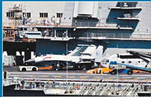
■一架殲-15艦載機模型正在右舷一號升降機進行升降測試。
