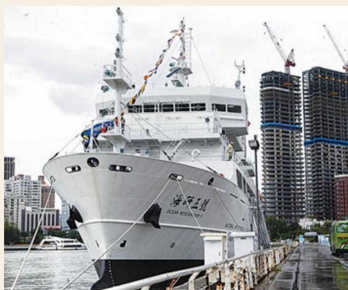
由台灣自行設計、建造2,700噸級，以油電力推動，具多功能特色的海研五號研究船10日舉行啟用典禮，為海洋科學研究再添生力軍。 中央社
