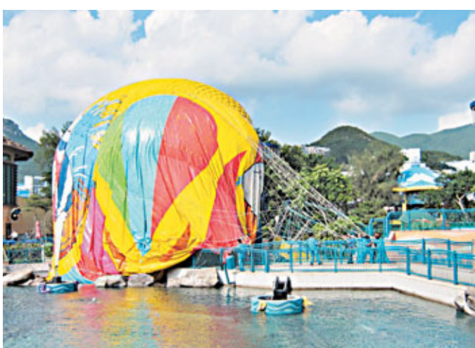
海洋公園的氦氣球因意外洩氣，偏離正常落點墜落水池旁邊花槽。
