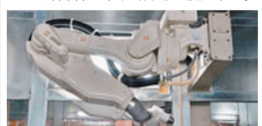
■一汽吉林二廠生產線的自動噴塗機器人
