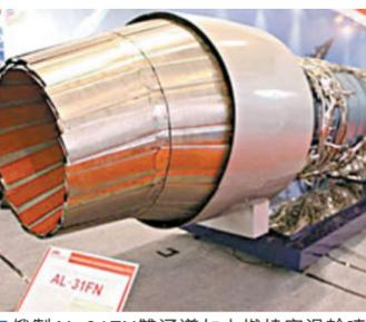
俄製AL-31FN雙涵道加力燃燒室渦輪噴氣發動機。 資料圖片
