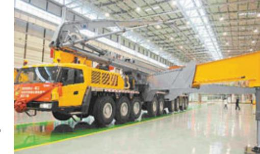
■圖為三一重工自主研發的86米9橋7節臂架車。
