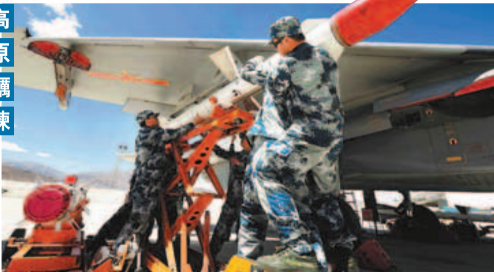
近日,空軍航空兵某團機務大隊在空軍駐藏某機場駐訓,期間針對高原低壓低氧的環境特點,對飛機進行適應性改裝,編寫高原保障手冊,提升高原作戰機務保障能力。駐訓以來,機務大隊共排除各類故障25起,實現飛機一次啟動100%成功率,保證了各項戰訓任務的圓滿完成。圖為機務人員在裝掛導彈。
