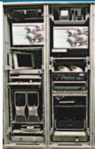
馬會引入的數碼終點照相系統，掃描速度達每秒1萬條線。香港文匯報記者劉國權攝
