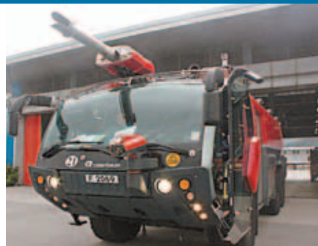
快速截擊車是撲滅飛機起火的先頭部隊,有水砲射出含化學泡沫的水。
