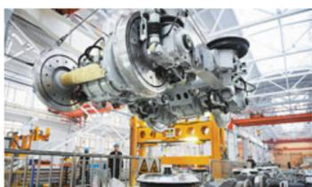
南車車間內，工人在高速動車組車體生產線上吊運轉向架。
