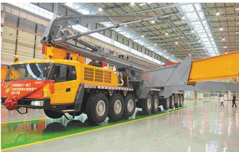
圖為由三一重工自主研發的86米9橋7節臂架泵車，實現了臂架最長、臂架節數最多、泵送排量最大等三項世界之最，標誌國產泵車設計製造技術邁向了一個新的高度。
