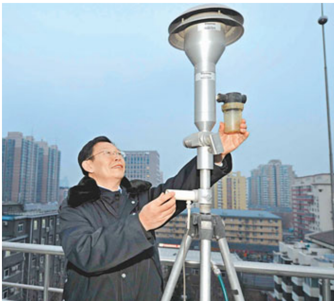
■北京環境保護監測中心工作人員在調整PM2.5監測設備。新華社
