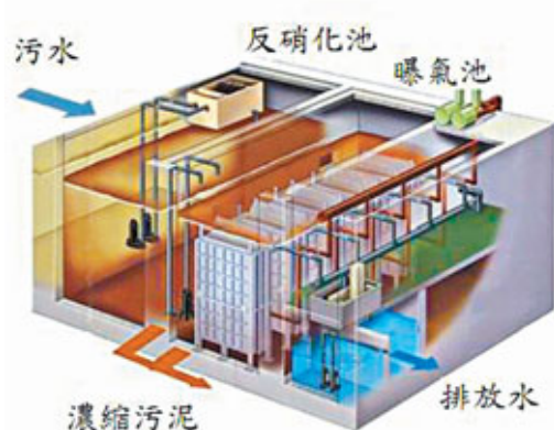
南丫島污水廠引入薄膜生物反應技術,污水經薄膜0.4微米細孔後,懸浮物及細菌將會被阻隔,淨化後污水達到2級處理水平。
