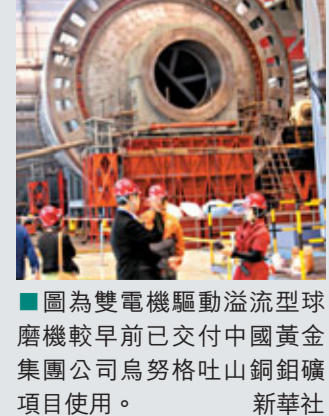
圖為雙電機驅動溢流型球磨機較早前已交付中國黃金集團公司烏努格吐山銅鉬礦項目使用。
