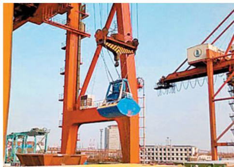
天津港為配合集裝箱岸橋接卸散糧，首次使用最新研製的電動抓斗和遙控液壓抓斗。
