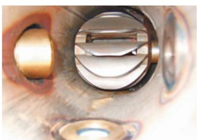
微型水力發電系統運作原理是利用1個微型球狀體渦輪,回收水管內水流的剩餘水壓,轉化為電能。
