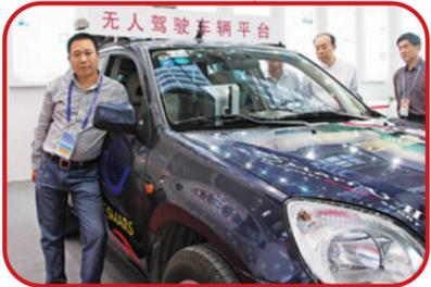
據悉,該無人駕駛車輛平台由武漢大學交通研究中心研發,汽車前方雷達160度的近距離掃描可以及時發現前方障礙物,後方雷達360度的掃描可觀測遠方障礙物,只要在車內的電子系統上確定目的地和所走路線便可上路。行車過程中,該車能自動變道、拐彎等,到目的地後車輛還會自動尋找停車位,安全泊車。
