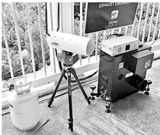
■環保署建議於2013年初開始，在路邊設置汽車廢氣遙測儀器，偵測排放過量廢氣的汽油和石油氣車輛。 香港文匯報記者林曉晴攝
