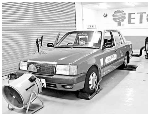
■被路邊汽車廢氣遙測儀器偵測到排放過量廢氣的車輛，需往廢氣檢測中心以底盤式功率機進行廢氣測試。 香港文匯報記者林曉晴攝
