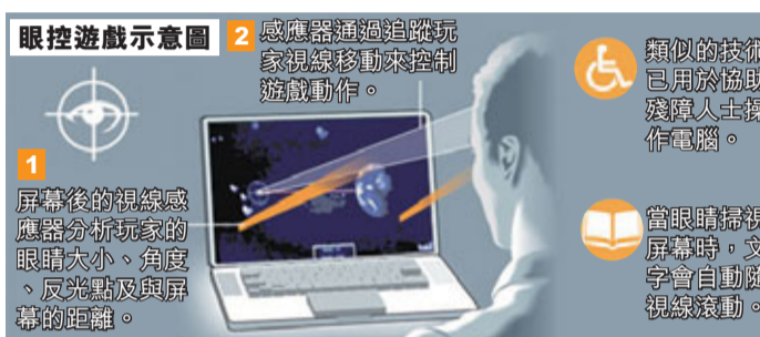
■ 眼控遊戲示意圖 1 屏幕後的視線感應器分析玩家的視線大小、角度、反光點及與屏幕的距離。 2 感應器通過追蹤玩家的視線移動來控制遊戲動作。 類似的技術已用於協助殘障人士操作電腦。 當眼睛掃視屏幕時，文字會自動隨視線移動。
