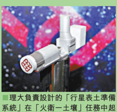
理大負責設計的「行星表土準備系統」在「火衛一—土壤」任務中起關鍵作用，可把「火衛一」土壤樣本帶返地球進行分析。理大供圖
