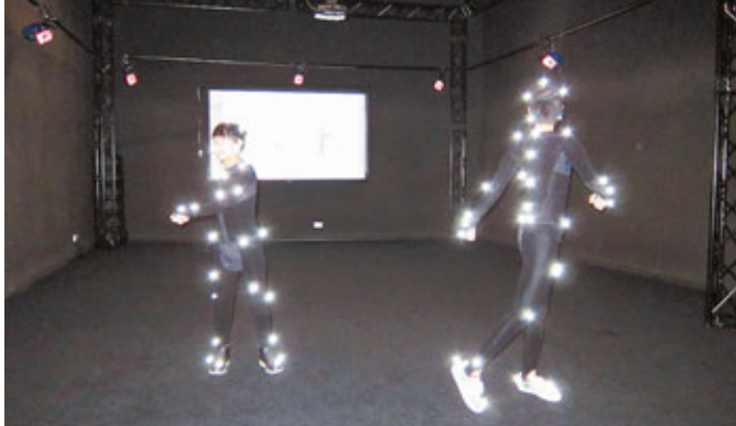
■中心內有全港最大型的動作捕捉系統實驗室，在黑漆漆的實驗室內置有24個紅外線鏡頭，配合貼在人體上的反光點，以捕捉人類的每個動態製作3D電影。香港文匯報記者勞雅文 攝
