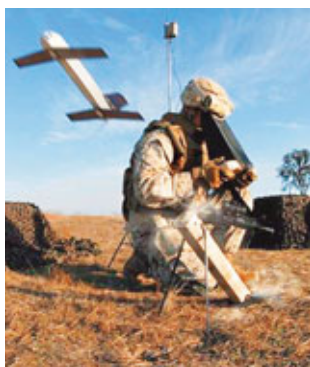
從空中向地面的士兵發回實時影像，讓士兵鑒別敵人。一旦確認敵人目標，操縱這種飛行器的士兵會向它發出指令，使其調整到作戰狀態，並順著軌道對目標發射攻擊。最後，它擊中目標，引爆內部小型爆炸物。
