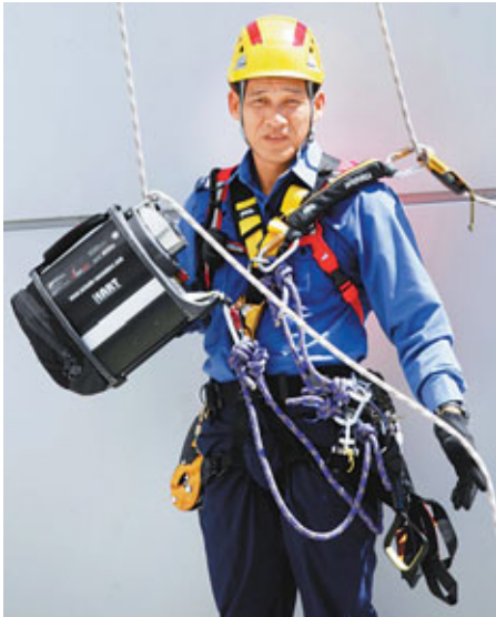
■高角度搜救專隊隊員利用電動上升器，可自行操作上升或下降，毋須隊友高位拉動繩索，可減少體力消耗。 香港文匯報記者曾慶威攝
